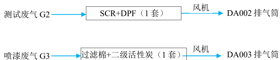
图 4-1 本项目废气收集及治理流程图
