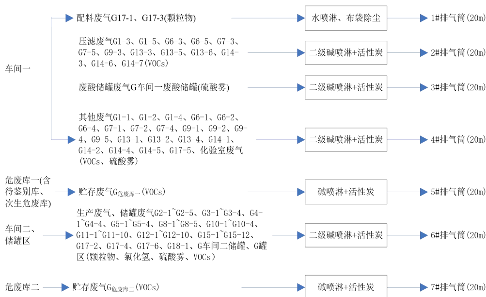
图 7.1-1 本项目废气收集系统走向图
