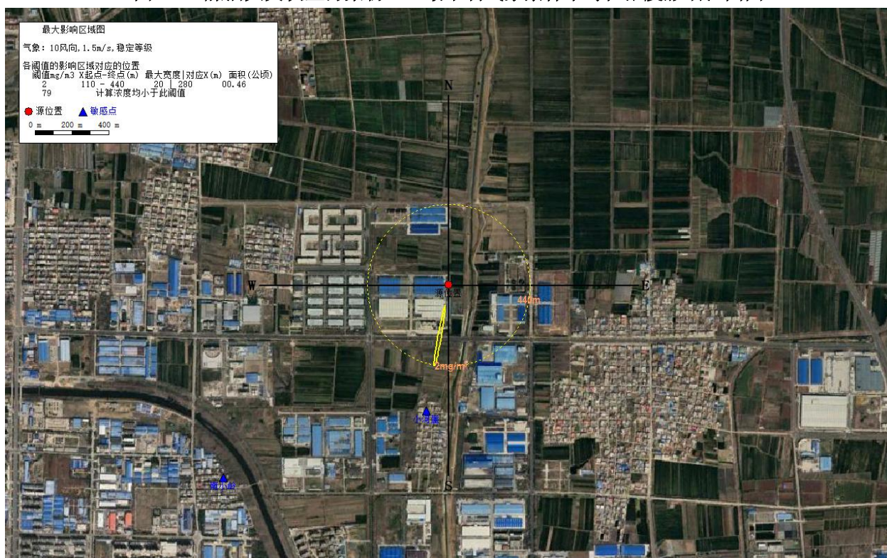
图 6.9-3 煤油火灾次生污染物 SO 2 最不利气象条件下毒性浓度影响范围图
